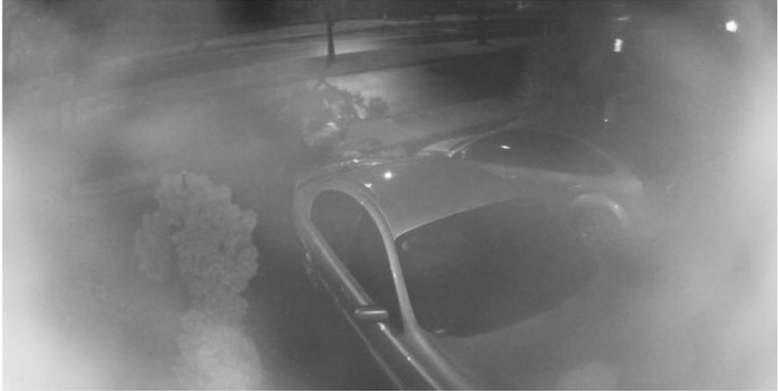
Ceci est généralement causé par la réflexion de l'infrarouge dans l'objectif. L'illumination peut également se refléter dans le bulbe transparent. Les principales causes de cette réflexion peuvent être les suivantes:
