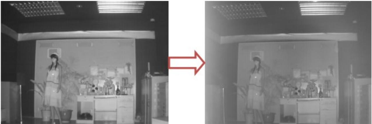
Des cartons en premier plan sont positionnés à environ 1 mètre de l'objectif de la caméra, même si ces cartons ne sont pas visibles par l'objectif il reflètent l'illumination infrarouge et l'arrière plan devient flou.
