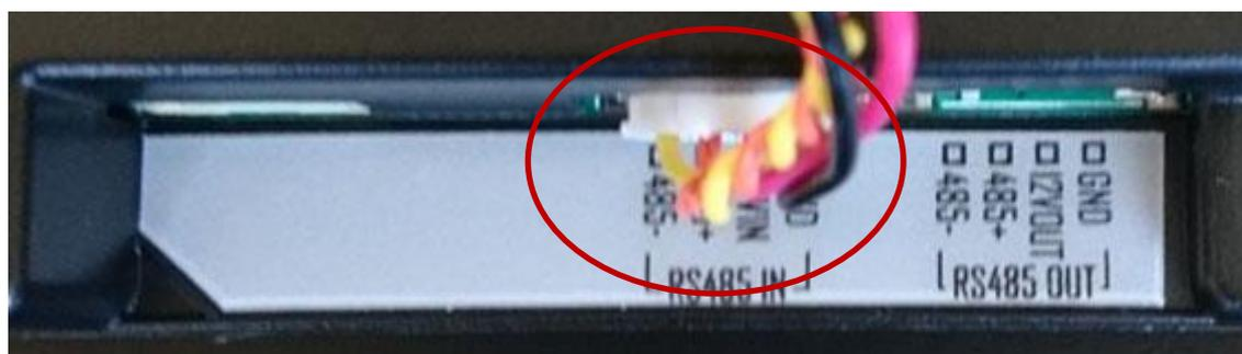
Pour connecter des modules en cascade (si vous avez 3 modules ou plus), il faut connecter le câble RS485 venant du module précédent sur RS485 OUT et le suivant sur RS485 IN.
