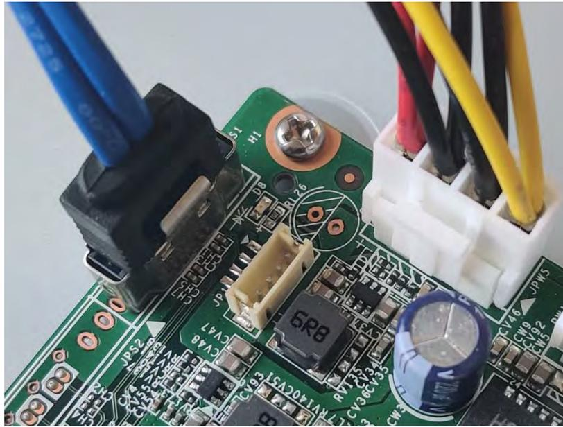
3. Placez le disque dur de manière à ce que la distance entre les fiches du disque et les prises raccordées dans l'étape 2 soit la plus petite possible.
