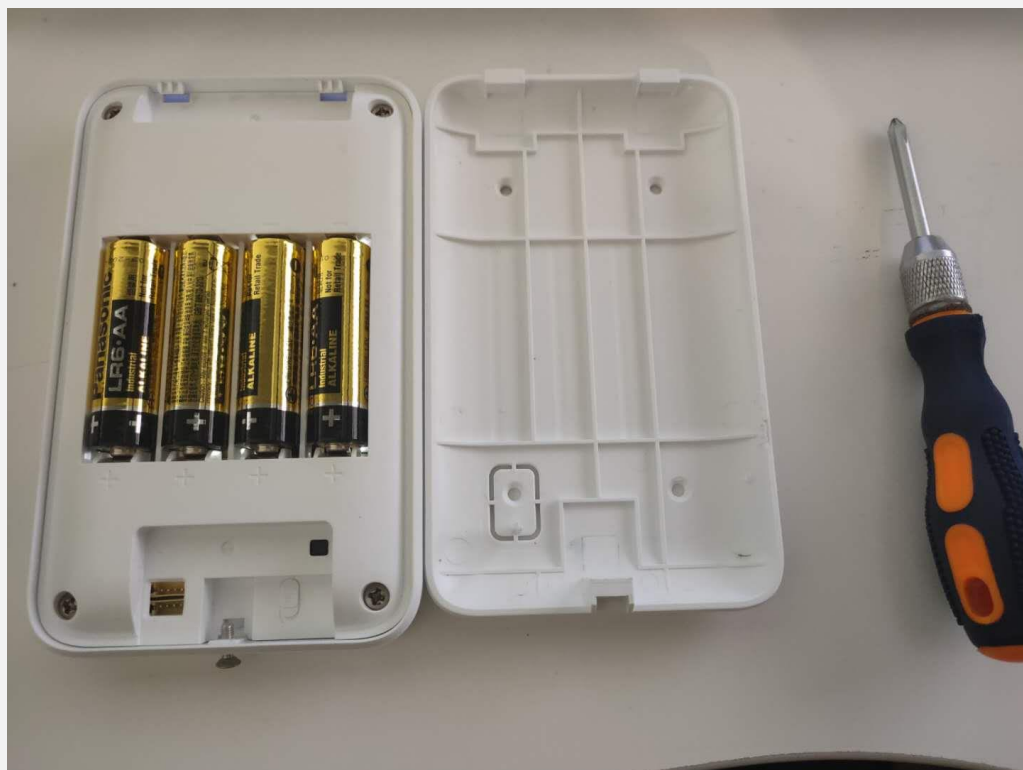
Ouvrir le clavier avec un tournevis
